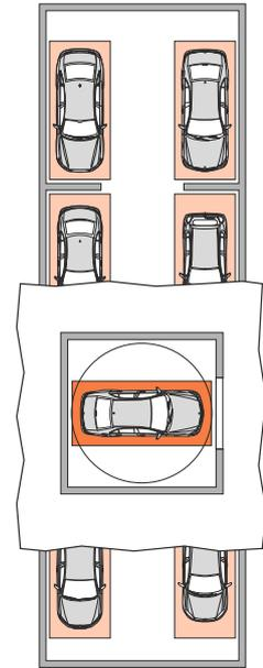
Установка поворотного круга во въездном боксе позволяет въезд и выезд из системы под любым желаемым углом.
